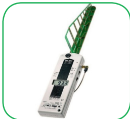
■ شکل ۱۳. دستگاه اندازه‌گیری شدت، جهت و نوع امواج الکترومغناطیسی
