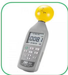
■ شکل ۱۴. دستگاه اندازه‌گیری شدت امواج الکترومغناطیسی در فرکانس رادیویی
